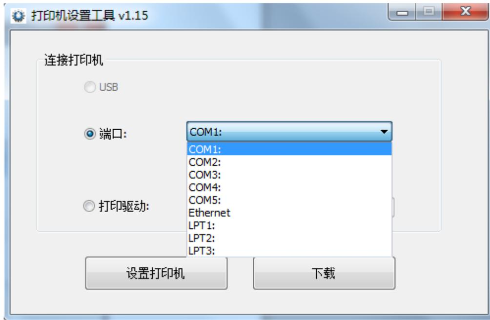
端口可以通过串口、网口以及并口，进行“配置端口”后，连接打印机，然后进行“设置打印机”或者进行程序“下载”。
