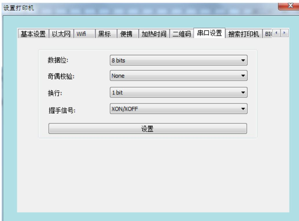
注：对串口进行设置后，打印机的串口参数已经改变，需要返回到主界面，对串口进行重新配置（配置参数与你修改后的参数要一致）
