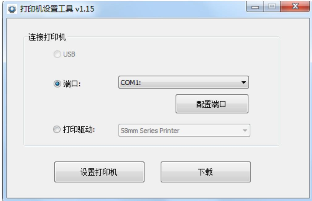
如上图所示，有 3 种方式，连接到打印机。
